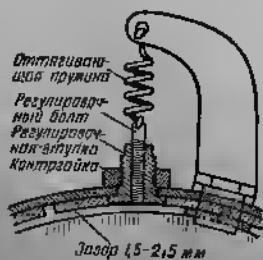
Рис. 176. Регулировочный болт в оттягивающей пружине: 1 — оттягивающая пружина; 2 — регулировочный болт; 3 — регулировочная муфта; 4 — контргайка
